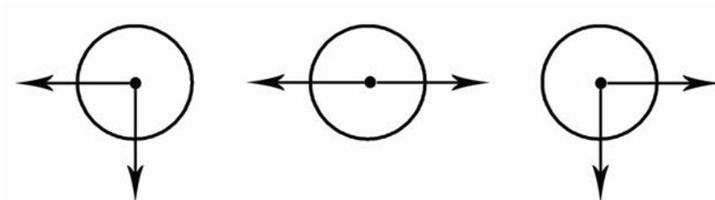
Рис 4. Направление потока рабочей среды
